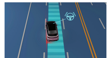
Lane Departure Warning (LDW) ระบบช่วยเตือนเมื่อรถออกนอกเลน
