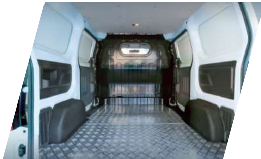
พื้นอลูมิเนียมอัลลอย และผิวกันลื่นที่ทนทาน สะดวกต่อการบรรทุกสินค้าในหลายรูปแบบ
