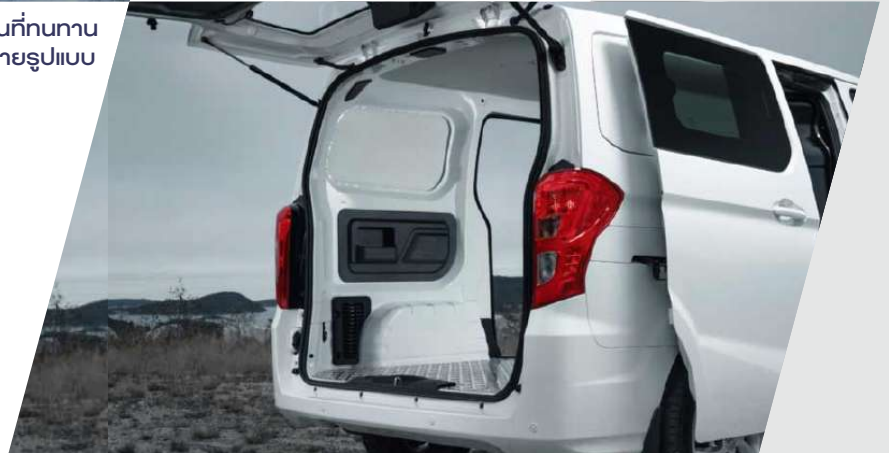
พื้นที่บรรทุกสินค้าขนาดใหญ่ 3,800 ลิตร รองรับน้ำหนักได้กว่า 700 กิโลกรัม ตอบโจทย์ทุกความต้องการในระบบขนส่งในเมืองได้เป็นอย่างดี
